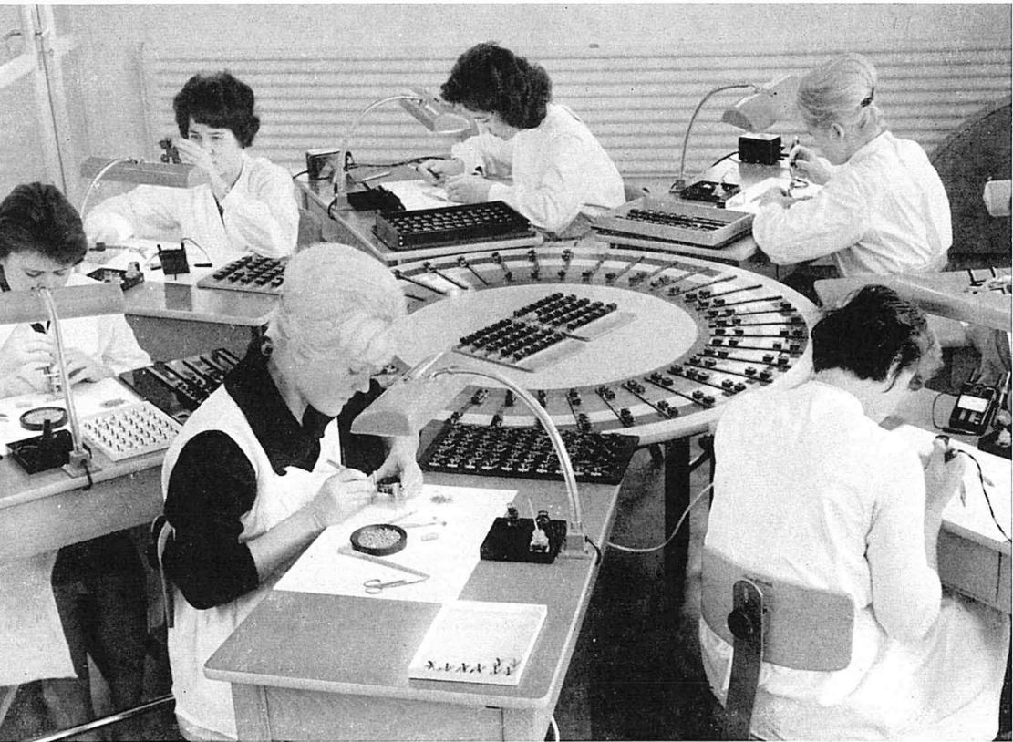
Abb. 24: Modernes Kreisfließband der Firma Gossen, dessen Mehrteiligkeitsprinzip den Fließbandarbeiter von allzu großem Zeitzwang befreit; die außerordentliche Akribie erfordernden feinmechanischen Teilarbeiten werden meist im Stücklohn geleistet.
