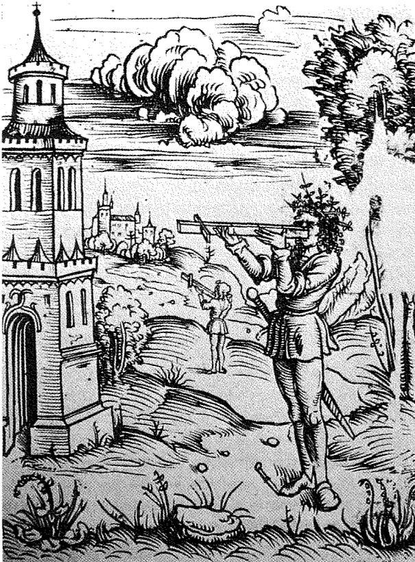
*Abb. 2: Messung mit dem Jakobsstab, 1502*
