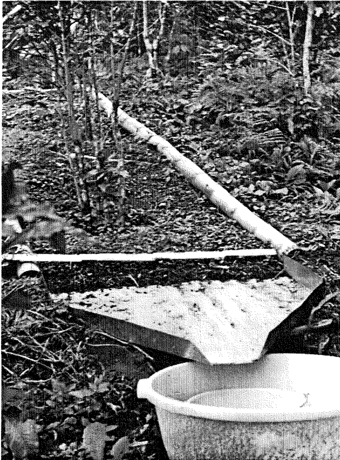
Abb.3: Ansicht von Erosionsmeßparzelle 5 mit Ablaufblech und Auffangeinrichtung für Oberflächenabfluß und Bodenabtrag
