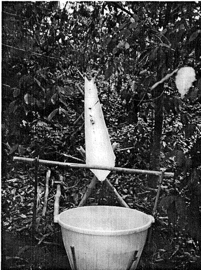
Abb.4: Interzeptionsrinne zur Ermittlung des Kronenrückhaltes von Niederschlägen in einer Kaffeepflanzung mit starker Beschattung
